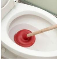
**プランジャー(吸引式下水掃除棒):**プランジャーとは、棒の先にゴムでできたカップがついていて、トイレや流しのパイプの詰まりをなおすために使う道具です。水を吸引する時に水がこぼれてしまうことがあるので、水の量が多いと思ったら、まずバケツを用意し、水をすくい、量を減らしてから吸引するようにしましょう。まず、プランジャーをトイレの穴に向けて押し空気を押し出します。最初はあまり力を入れずに押しましょう。それからプランジャーをトイレの穴につけたまま、何回か素早く押し続けます。これを20秒ほど続けます。そしてプランジャーを離すと、水が通るようになります。もしそれでも水が通らない場合は、10分ほど待ち、同じことを繰り返します。水が流れるかもしれないと思って、トイレの水のレバーを引くことはしないでください。プランジャーの使い方については、YouTubeでも見るができます。もしトイレの水がこぼれてしまったら、床をきれいに掃除するか周りの大人に知らせてください。床やそのまわりを破損してしまった場合には、修理代を請求されることもあります。
